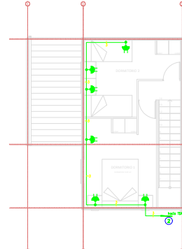
ENCHUFES VIVIENDA TIPO 5 2°PISO ESCALA: 1:50
